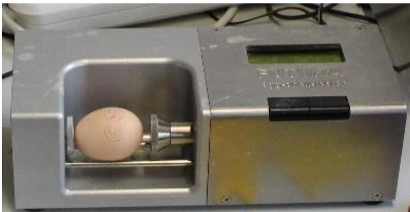
Abbildung 5: Bruchfestigkeits-Messgerät zur Bestimmung der Schalenstabilität
